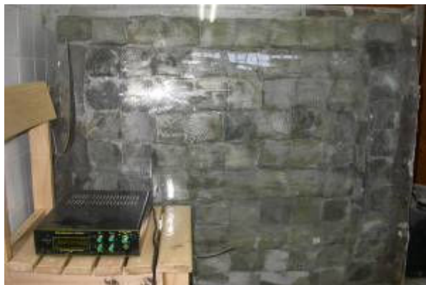
شکل ۱. در این تصویر اطاقک محدود کننده امواج به همراه دستگاه مولد امواج مایکروویو دیده می شود.
